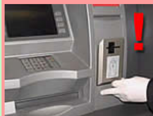
Okienko wrzutowe z założonym dodatkowym czytnikiem kart
